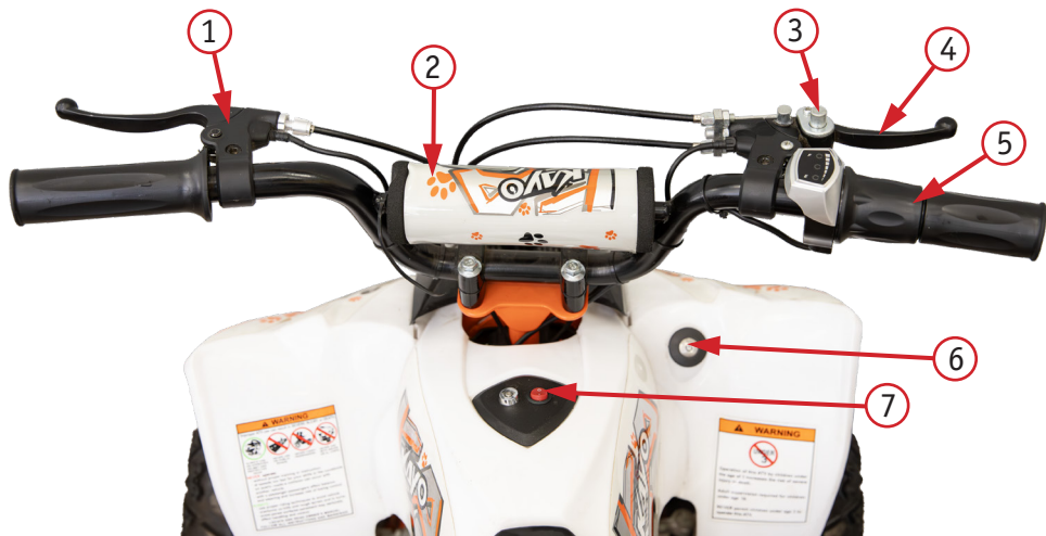
Фото 2.5.1. Органы управления модели eA50: 1 – рычаг заднего тормоза; 2 – мягкая рулевая накладка; 3 – стопор рычага переднего тормоза; 4 – рычаг переднего тормоза; 5 – рукоятка скорости; 6 – кнопка включения питания; 7 – кнопка переключения направления движения (вперед-назад)
