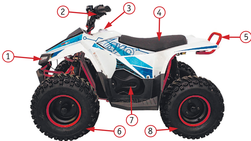
Фото 2.1. Левая сторона модели eA70: 1 – фара; 2 – руль с органами управления; 3 – спидометр; 4 – седло; 5 – задний бампер; 6 – переднее колесо; 7 – аккумуляторная батарея; 8 – заднее колесо
