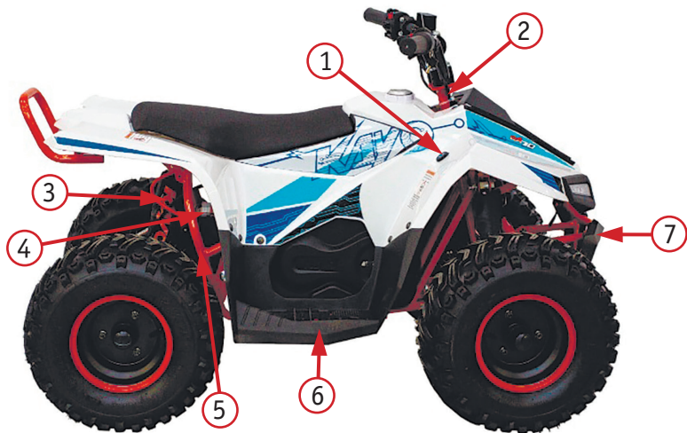
Фото 2.2. Правая сторона модели eA70: 1 – замок включения питания; 2 – вал рулевого управления; 3 – задний амортизатор; 4 – электродвигатель; 5 – рама; 6 – правая подножка; 7 – передний бампер
