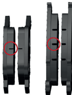
Фото 5.10. Определение износа тормозных колодок
