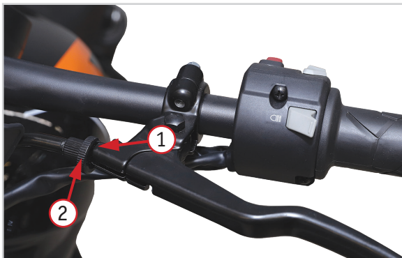
Фото 2.11. Регулировка сцепления: 1 – стопорная гайка; 2 – регулировочный винт
