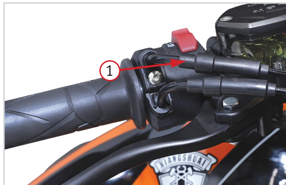
Фото 3. Регулировка троса газа: 1 – защитный колпачок
