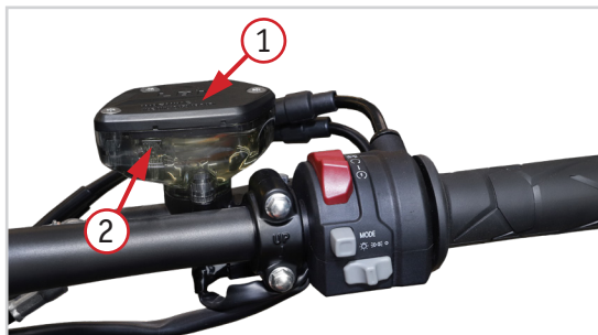
Фото 5.8 Уровень тормозной жидкости переднего и заднего тормозов: 1 – крышка; 2 – отметки минимум и максимум
