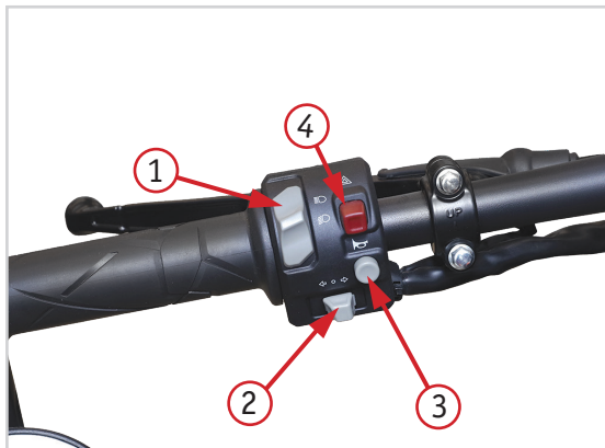
Фото 2.4 Левый комбинированный переключатель: 1 – переключатель режима света фары (дальний свет/ ближний свет); 2 – клавиша указателей поворота; 3 – кнопка звукового сигнала; 4 – кнопка аварийной сигнализации; 5 – кнопка включения дальнего света при обгоне
