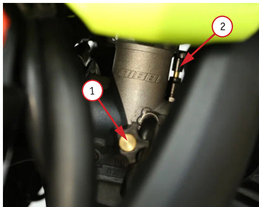
Фото 5.5. Регулировка холостых оборотов (вариант 1): 1 – винт регулировки холостых оборотов (вид винта может отличаться); 2 – ручка обогатителя топливной смеси
