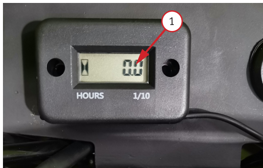
Фото 3.4. Счетчик наработки для мотоциклов без ПТС: 1 – показатель наработки (моточасы)
