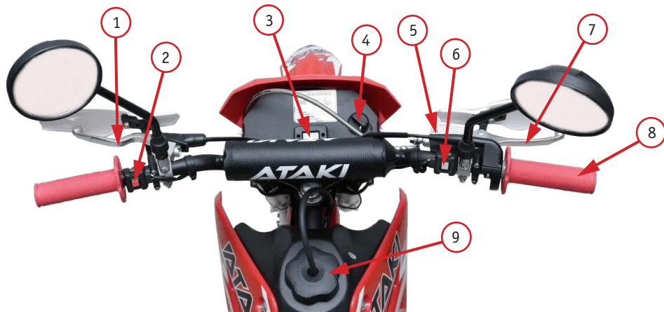
Фото 2.3.1 Приборы и органы управления мотоцикла ATAKI SX150: 1 – рычаг сцепления; 2 – кнопка выключения двигателя; 3 – счетчик наработки; 4 – замок зажигания с ключом; 5 – передний бачок с тормозной жидкостью; 6 – кнопка электростартера; 7 – рычаг переднего тормоза; 8 – ручка газа (акселератора); 9 – крышка бака
