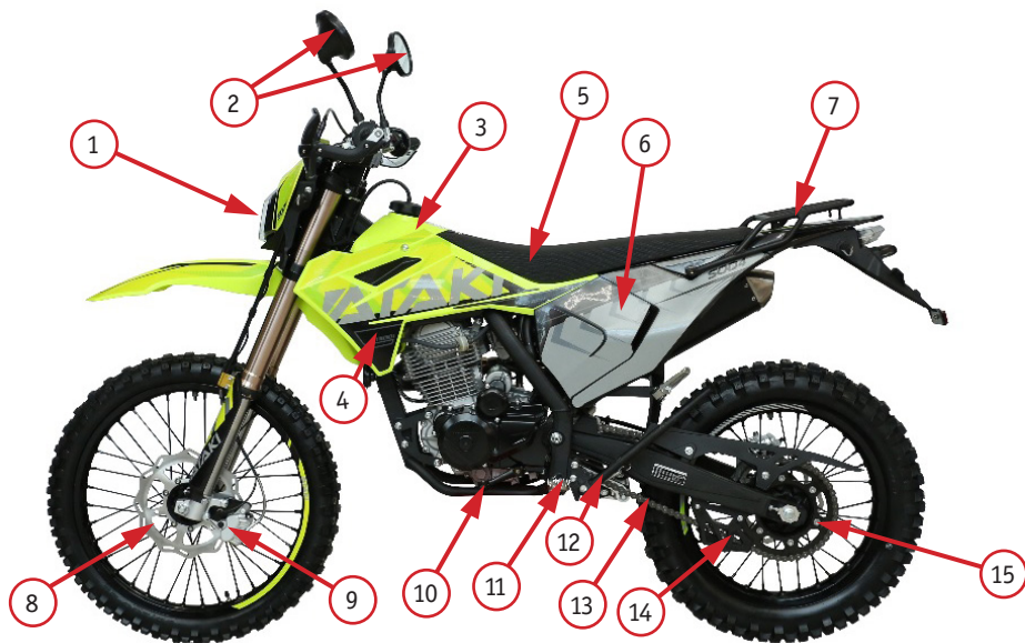
Фото 2.1 Вид мотоцикла АТАКИ S004 300 (с ПТС) слева: 1 – фара; 2 – зеркала заднего вида; 3 – топливный бак; 4 – топливный кран (под обвесом); 5 – сиденье; 6 – воздушный фильтр (за обвесом); 7 – задний багажник; 8 – передний тормозной диск; 9 – передний тормозной суппорт; 10 – рычаг переключения передач; 11 – левая подножка; 12 – боковая подставка; 13 – приводная цепь; 14 – уловитель цепи; 15 – задняя звездочка
