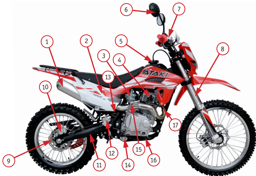
Фото 2.2.1 Вид мотоцикла АТАКИ SX150 справа: 1 – глушитель; 2 – воздушный фильтр (за обвесом); 3 – карбюратор; 4 – свечной колпачок; 5 – крышка топливного бака; 6 – зеркало заднего вида; 7 – передний тормозной бачок; 8 – передний амортизатор; 9 – задний тормозной диск; 10 – задний тормозной суппорт; 11 – маятник; 12 – задний тормозной цилиндр; 13 – задний амортизатор; 14 – правая подножка; 15 – кик-стартер; 16 – рычаг заднего тормоза; 17 – выхлопной патрубок
