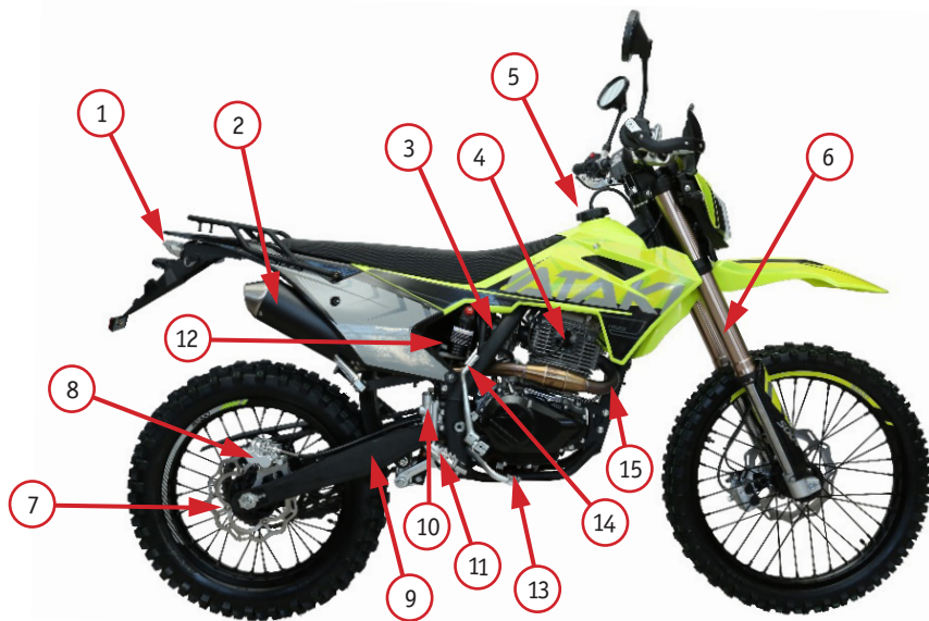
Фото 2.2. Вид мотоцикла АТАКИ S004 300 (с ПТС) справа: 1 – задний фонарь; 2 – глушитель; 3 – карбюратор; 4 – свечной колпачок; 5 – крышка топливного бака; 6 – передняя вилка; 7 – задний тормозной диск; 8 – задний тормозной суппорт; 9 – маятник; 10 – задний тормозной цилиндр; 11 – правая подножка водителя; 12 – задний амортизатор; 13 – педаль тормоза; 14 – кик-стартер; 15 – выхлопной патрубок
