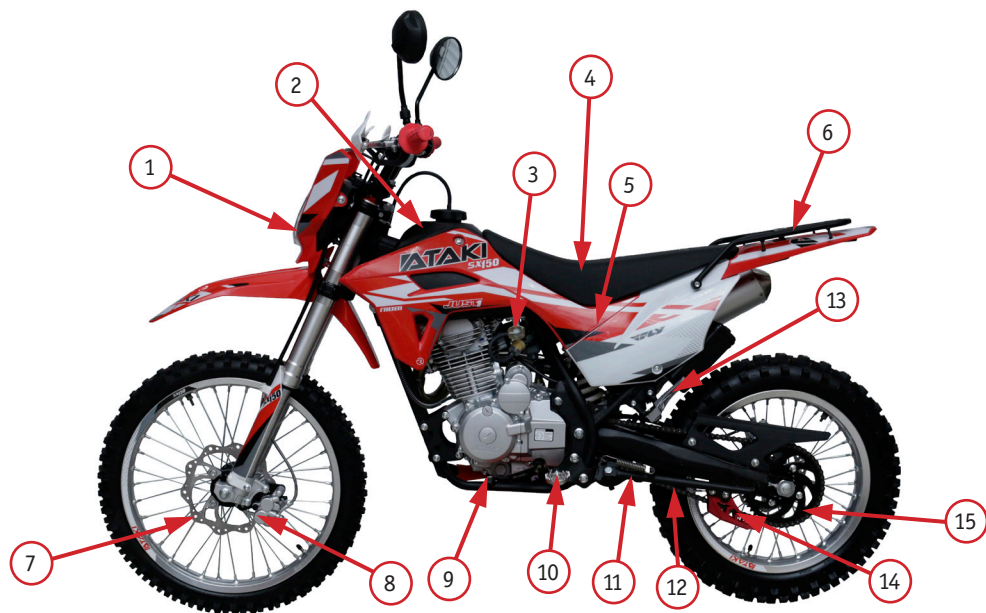
Фото 2.1.1 Вид мотоцикла ATAKI SX150 слева: 1 – фара; 2 – топливный бак; 3 – топливный кран; 4 – сиденье; 5 – аккумуляторная батарея (за обвесом); 6 – задний багажник; 7 – передний тормозной диск; 8 – передний тормозной суппорт; 9 – рычаг переключения передач; 10 – левая подножка водителя; 11 – боковая подставка; 12 – приводная цепь; 13 – левая подножка пассажира; 14 – уловитель цепи; 15 – задняя звездочка
