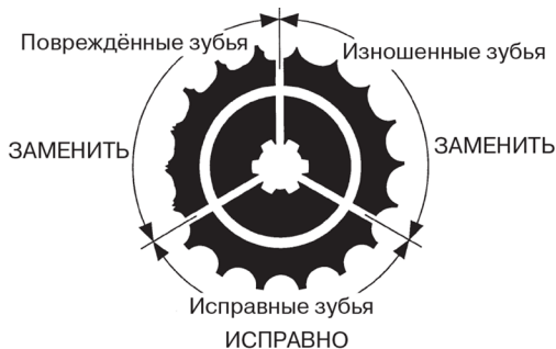
Рисунок 3. Вид зубьев звездочки
