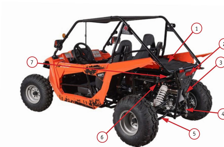
Фото 2.4. Вид квадрицикла сзади: 1 – топливный бак; 2 – фара стоп-сигнала; 3 – глушитель; 4 – прицепное устройство; 5 – рама подвески заднего колеса; 6 – двигатель ; 7 – задний указатель поворота
