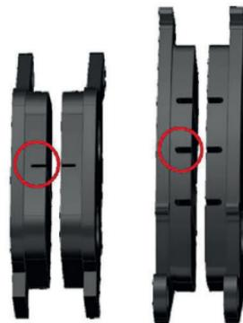
Фото 5.10. Определение износа тормозных колодок
