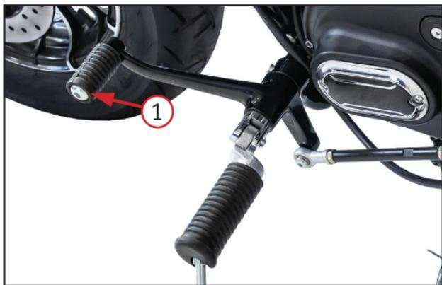
Фото 2.12. Рычаг переключения передач – 1
