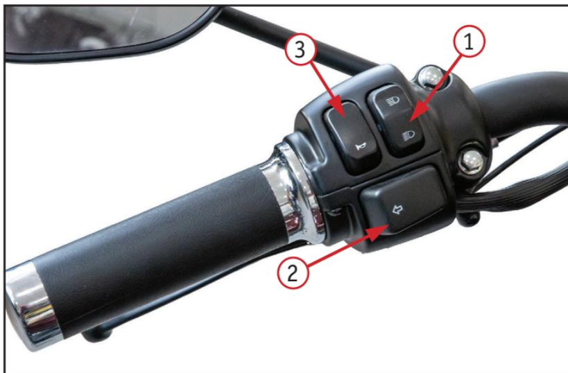
*Фото 2.4 Левый комбинированный переключатель: 1 – кнопка переключения режима света фары (дальний свет/ближний свет); 2 – кнопка левого указателя поворота; 3 – кнопка звукового сигнала*
