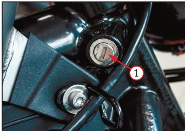
Фото 2.9.2 Замок блокировки рулевой колонки – 1
