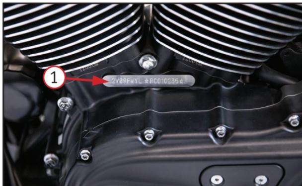
Фото 1.1. Слева на картере нанесен серийный номер двигателя – 1
