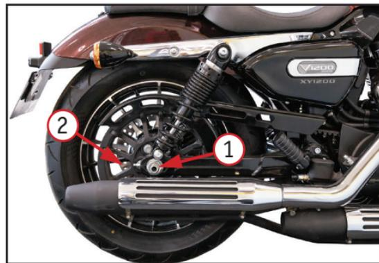
Фото 5.9 Регулировка ремня: 1 - гайка задней оси; 2 - регулировочный болт
