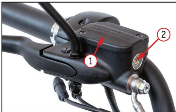
*Фото 5.8 Уровень тормозной жидкости переднего тормоза: 1 –крышка; 2 – минимум*
