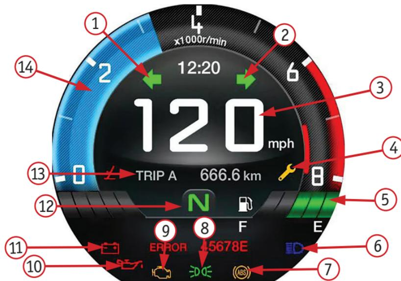
Фото 2.10. Вид приборной панели: 1 – индикатор левого поворотника; 2 – индикатор правого поворотника; 3 – скорость; 4 – индикатор технического обслуживания; 5 – количество топлива; 6 – индикатор дальнего света; 7 – индикатор ABS; 8 – индикатор габаритных огней; 9 – индикатор неисправности EFI; 10 – индикатор пониженного давления масла; 11 – индикатор пониженного напряжения батареи; 12 – индикатор нейтральной передачи; 13 – текущий/общий пробег; 14 – тахометр
