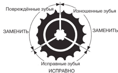
Рисунок 2. Износ звезд
