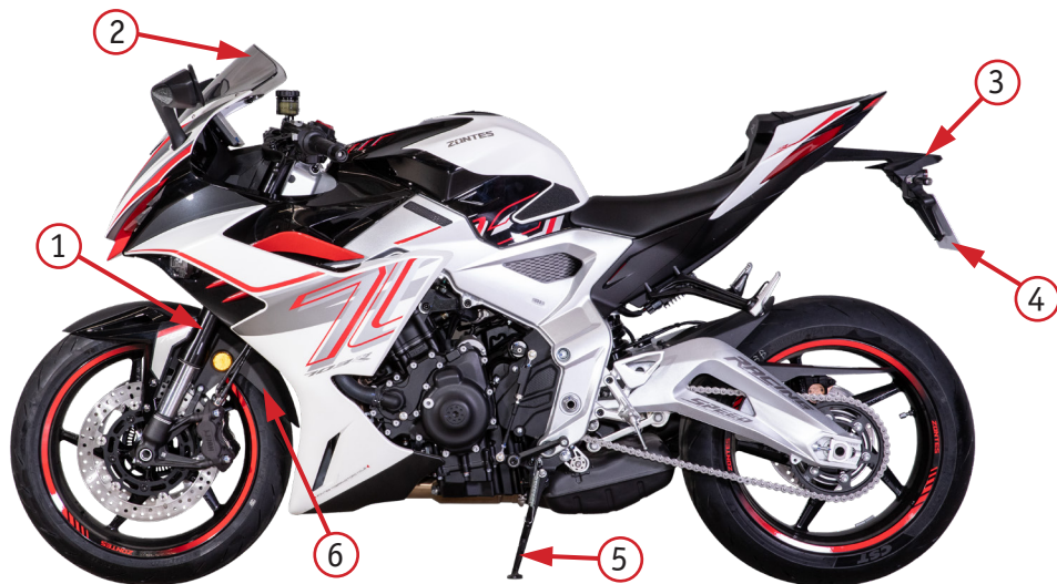
Фото 2.3 Вид слева: 1 – передние амортизаторы; 2 – ветровое стекло; 3 – задний фонарь; 4 – заднее крыло; 5 – центральная подставка; 6 – переднее крыло
