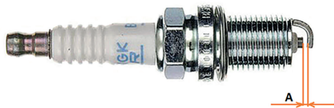
Фото 4.5. Зазор «А» между электродами свечи зажигания
