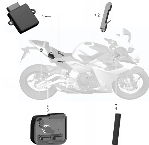
Фото 2.6. Система бесключевого доступа: 1 – блок РКЕ; 2 – индуктивная антенна; 3 – порт зарядки с предохранителями; 4 – приемо-передающая антенна
