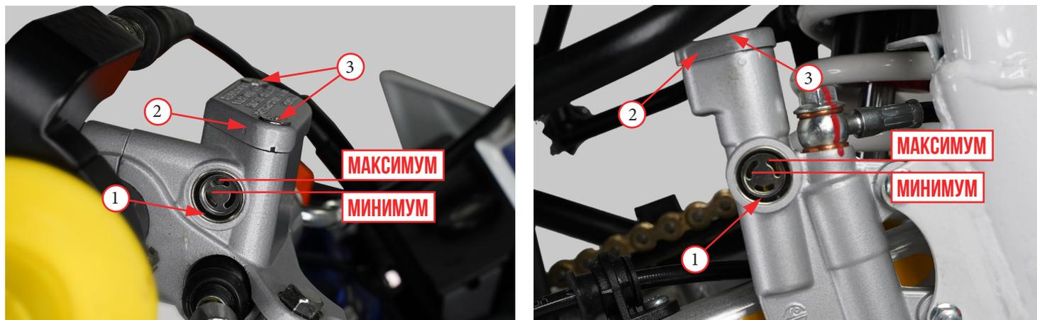
Фото 5.17. Контроль и долив тормозной жидкости
