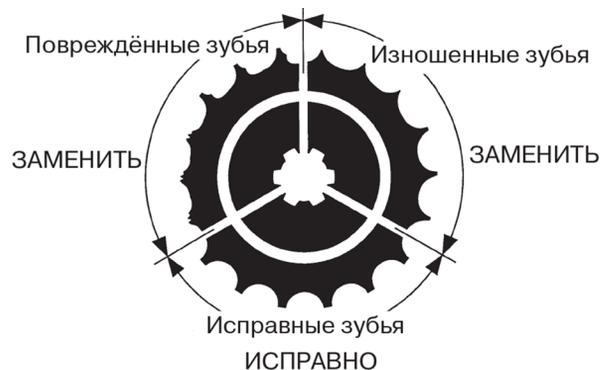
Рисунок 5.23. Вид зубьев звездочки
