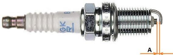
Фото 5.14. Зазор свечи зажигания.
