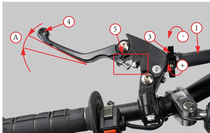
Фото 5.10. Регулировка свободного хода рычага сцепления (варианты исполнения)
