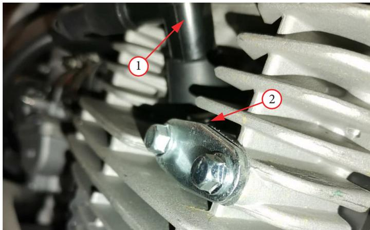
Фото 3.3. Свеча зажигания с колпачком: 1- колпачок;
