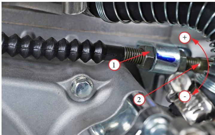
Если не удастся отрегулировать величину свободного хода или сцепление работает неправильно, это может указывать на износ или повреждение троса, либо на износ дисков сцепления.
