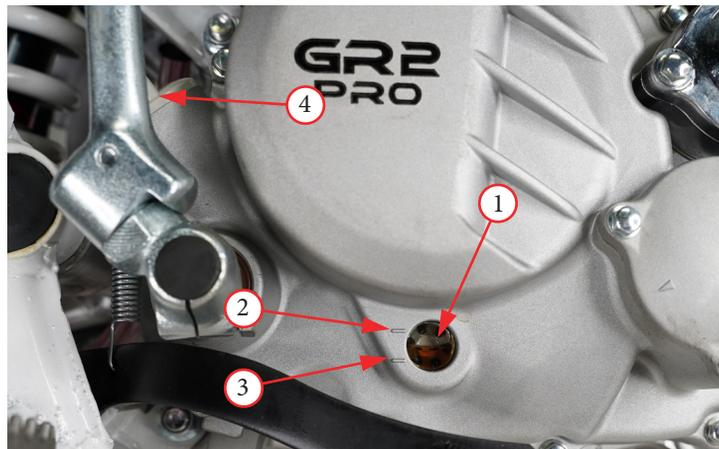
Фото 5.2. Варианты исполнения смотрового окна и крышки горловины двигателей ZS172FMM, ZS174MM:
