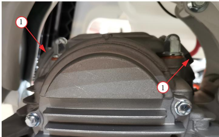
Фото 5.29. Крышки впускного и выпускного клапанов - 1.
