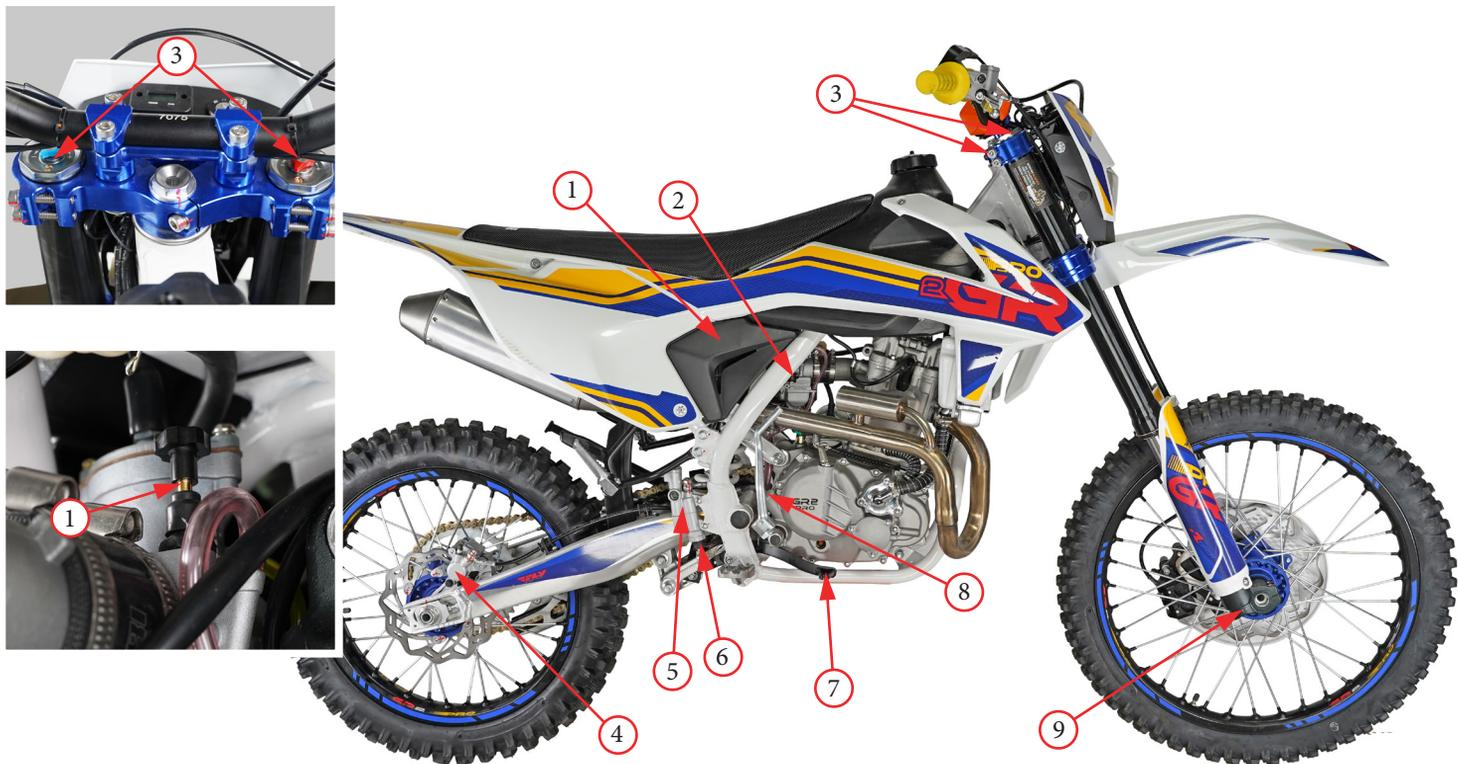
Фото 4.3. Узлы и механизмы (правая сторона): 1 - рычаг обогатителя топливной смеси (за обвесом); 2 - регулятор холостого хода; 3 - регуляторы хода сжатия передней вилки; 4 - суппорт заднего тормоза; 5 - задний тормозной бачок; 6 - регулятор педали задних тормозов; 7 - педаль заднего тормоза; 8 - крышка маслозаливной горловины; 9 - регулятор хода отбоя передней вилки.
