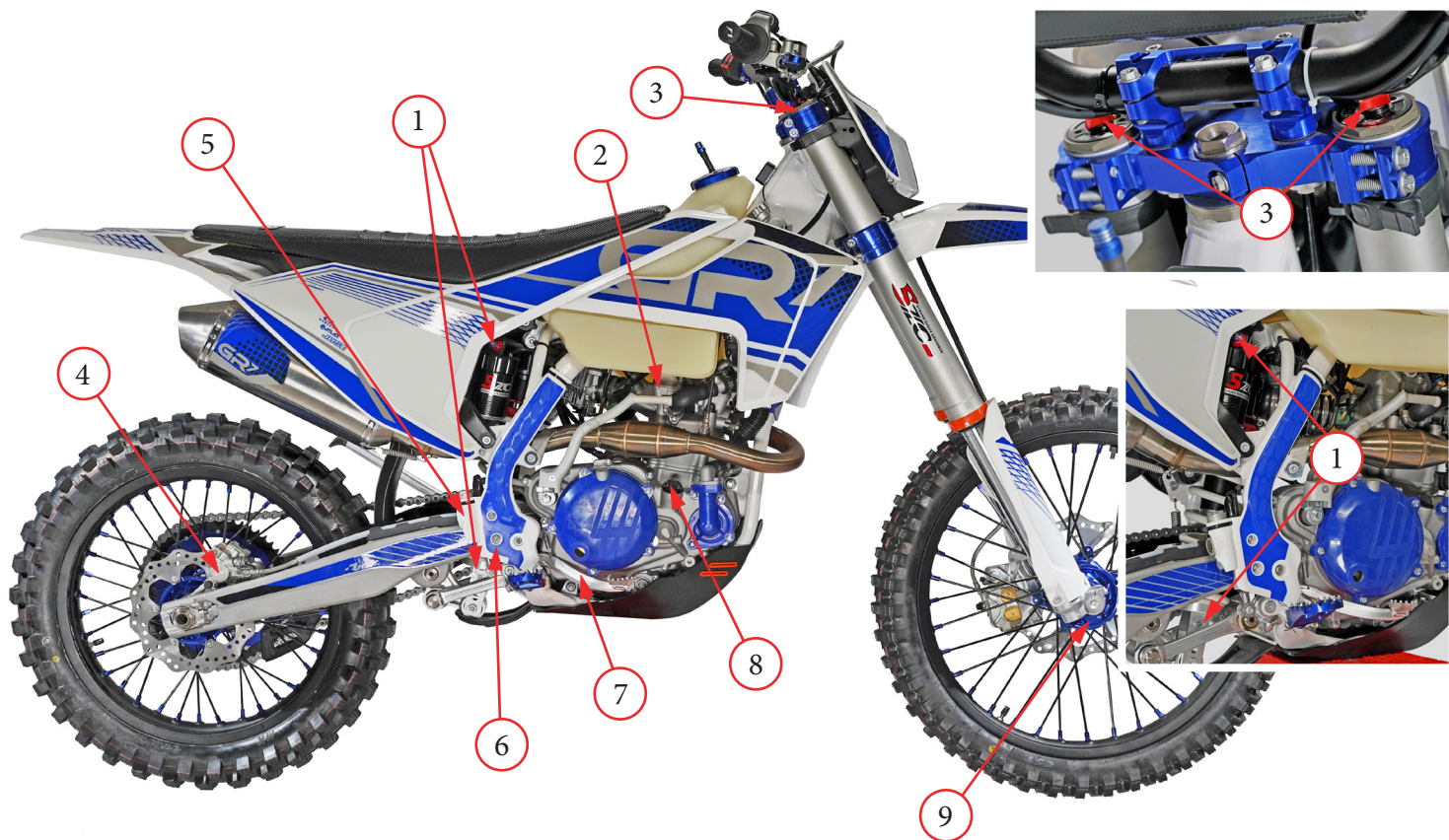
Фото 4.3. Узлы и механизмы с правой стороны: 1 - регуляторы заднего амортизатора; 2 - инжектор (карбюратор); 3 - регуляторы хода сжатия передней вилки; 4 - суппорт заднего тормоза; 5 - задний тормозной бачок; 6 - регулятор задних тормозов; 7 - педаль заднего тормоза; 8 - крышка маслозаливной горловины; 9 - регулятор хода отбоя передней вилки
