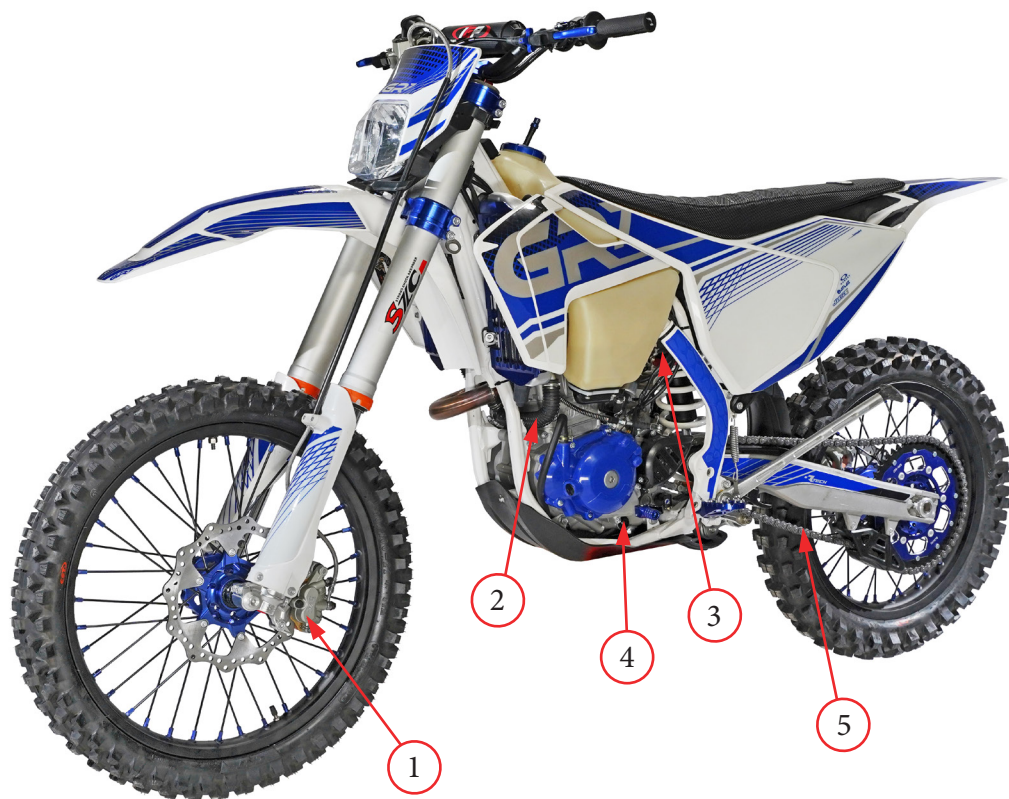
Фото 4.2.1. Узлы и механизмы с левой стороны (мотоцикл с инжектором): 1 - суппорт переднего тормоза; 2 - патрубki радиатора; 3 - воздушный фильтр; 4 - место размещения болта слива масла; 5 - приводная цепь
