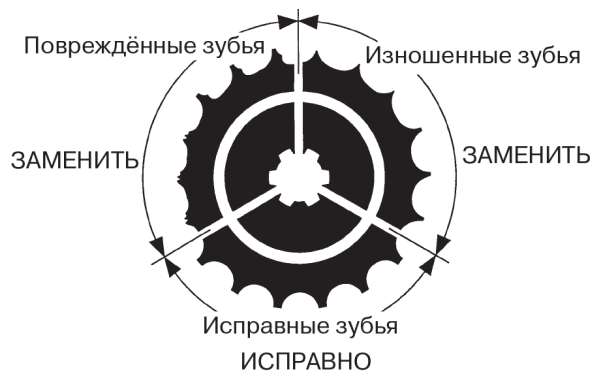
Рисунок 5.23. Вид зубьев звездочки
