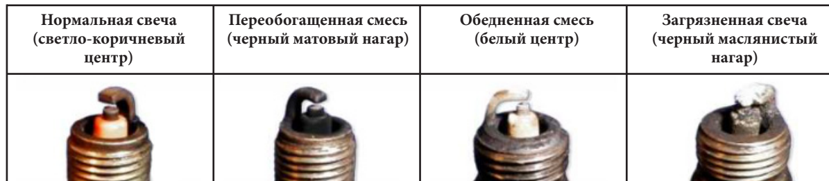
Фото 5.13. Состояния свечи зажигания
