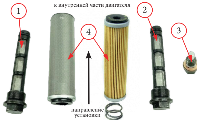
Фото 5.5.2. Части масляного фильтра
