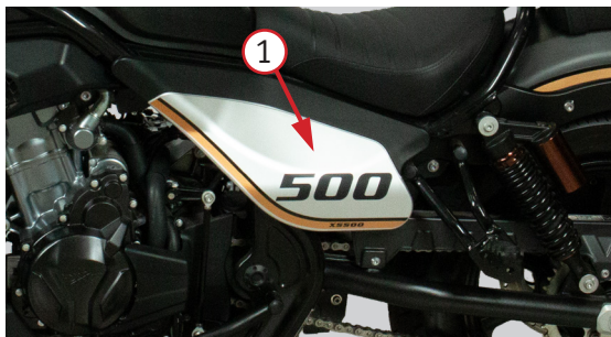
Фото 5.1 Обслуживание воздушного фильтра: 1 - пластиковая накладка
