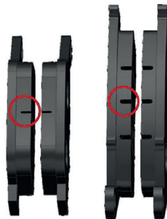
Фото 5.10. Определение износа тормозных колодок
