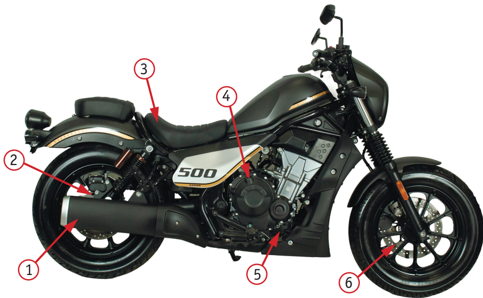
Фото 2.2. Вид справа: 1 – глушитель; 2 – задние дисковые тормоза; 3 – сиденье; 4 – заливная горловина для масла; 5 – педаль заднего тормоза; 6 – передние дисковые тормоза
