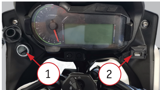
Фото 2.2. Порты для подключения внешних устройств: 1 – гнездо электрического подключения (12В / 10А); 2 – порт USB-подключения (5В / 1А).
