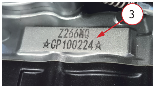
Фото 1.2. Справа на двигателе нанесен серийный номер двигателя 3.
