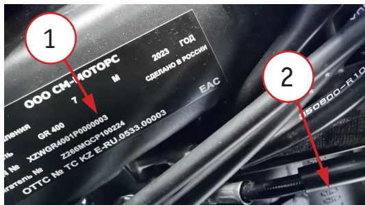
Фото 1.1. Этикетка с серийным номером и годом выпуска 1 расположена с правой стороны рамы. Надпись с VIN номером 2 нанесена на рулевом стакане.
