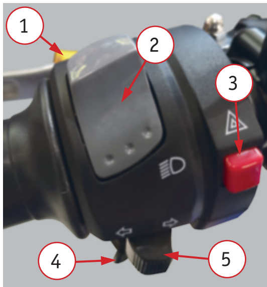
Фото 2.5. Левый блок переключателей: 1 – кнопка включения дальнего света при обгоне; 2 – клавиша переключения режимов фары; 3 – кнопка включения аварийной сигнализации; 4 – кнопка звукового сигнала; 5 – переключатель указателей поворота.
