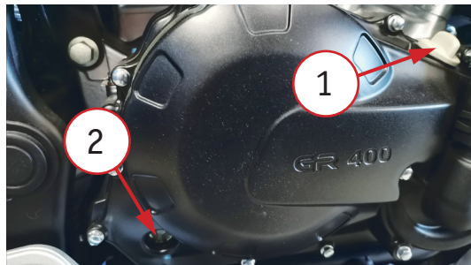
Фото 4.3. Замена масла: 1 – крышка заливной горловины; 2 – окно для контроля уровня масла.
