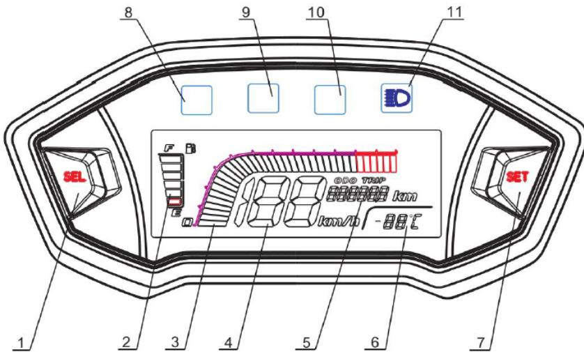
Рисунок 7. Приборная панель: 1 - кнопка «SEL» (слева) - кнопка выбора режима. Нажмите на эту кнопку, когда подсветка включена. Выберите, какие параметры необходимо отрегулировать, выбранный параметр будет мигать; 2 - индикатор уровня топлива; 3 - тахометр (об/мин); 4 - спидометр (км/ч); 5 - одометр (км); 6 - индикатор температуры окружающей среды; 7 - кнопка «SET» (справа).
