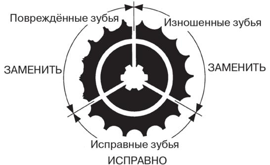
Рисунок 23. Вид зубьев звездочки.
