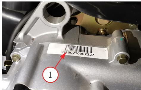
Фото 1.1 Место расположения серийного номера двигателя - 1.
