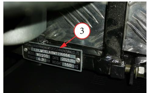
Фото 1.3 Место расположения номера VIN на модели WD150 (под сиденьем, с левой стороны рамы) - 3.
