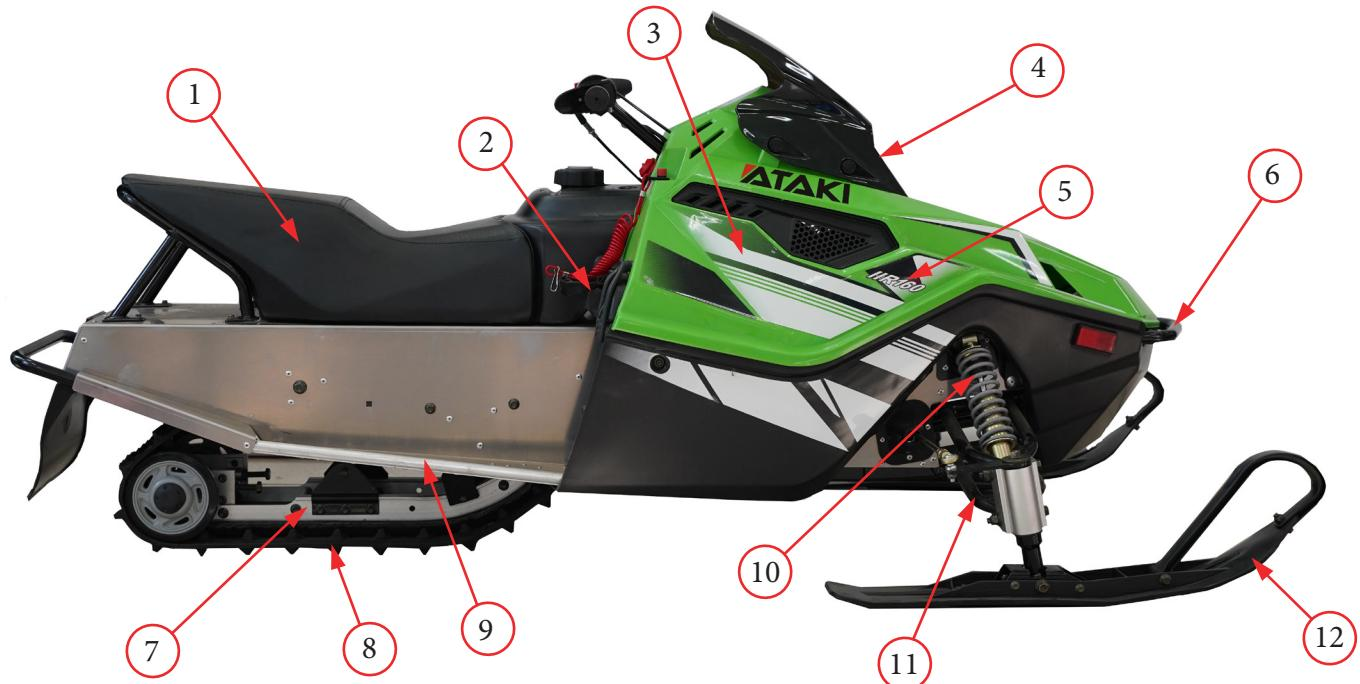
Фото 2.1.2 Узлы и части снегохода модели WD160: 1 – сиденье; 2 – рукоятка ручного запуска; 3 – карбюратор (под крышкой моторного отсека); 4 - фара; 5 - аккумулятор, предохранитель и электрические компоненты (под крышкой моторного отсека); 6 – передний бампер; 7 - узел задней подвески с роликами; 8 - резиновая гусеница; 9 – подножка водителя; 10 – амортизатор; 11 - поворотный кулак; 12 – лыжа.
