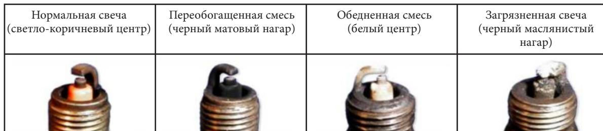
Фото 14. Состояния свечей зажигания.
