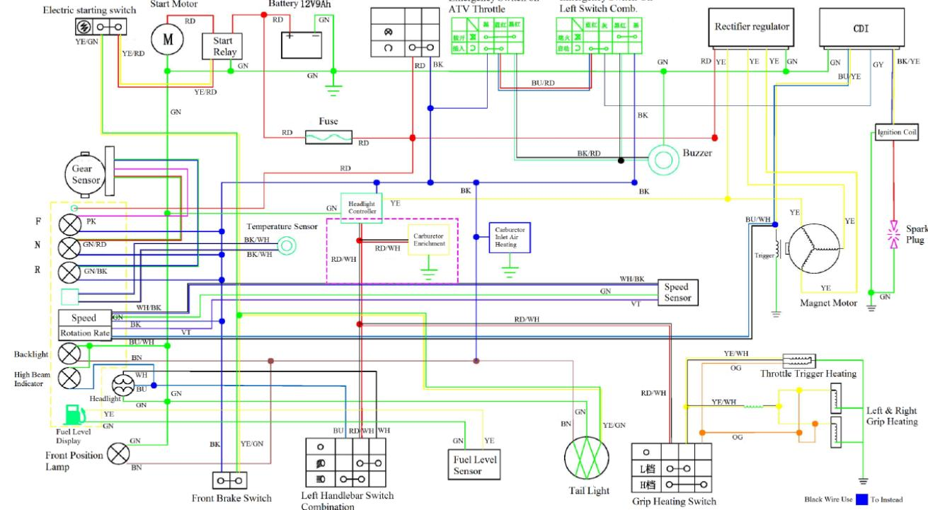
Схема 1. Электрическая схема снегохода WD150.
