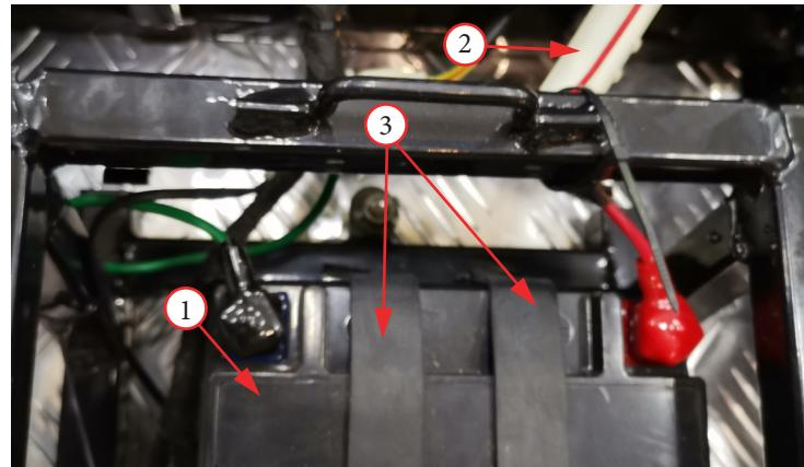
Фото 12. Снятие аккумуляторной батареи.
