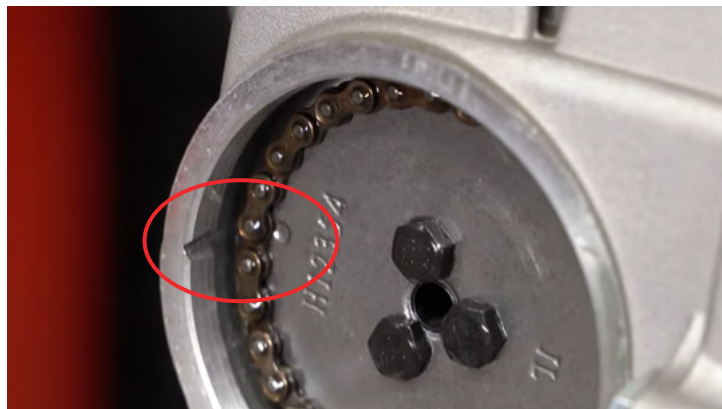
Фото 5.32. Совмещение меток в окне размещения звезды.
