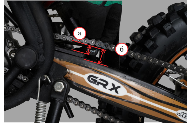
Фото 5.21. Замер провисания цепи.
