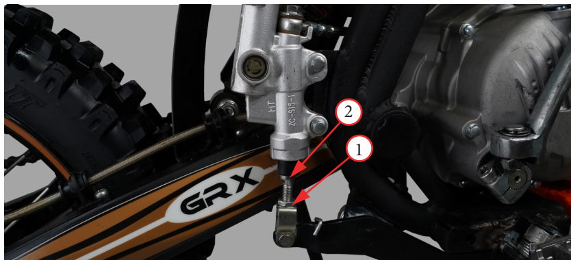
Фото 5.15. Регулировка высоты педали заднего тормоза.
