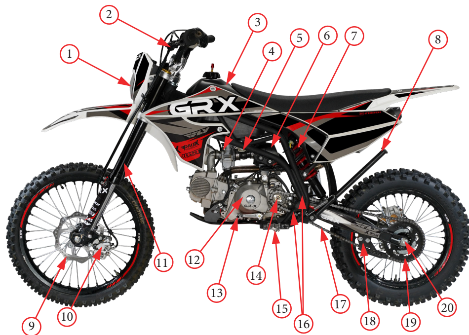
Фото 2.1. Левая сторона питбайка: 1 - фара; 2 - рычаг сцепления; 3 - топливный бак; 4 - карбюратор; 5 - топливный кран; 6 - воздушный фильтр; 7 - амортизатор задней подвески; 8 - стояночная подножка; 9 - передний тормозной диск; 10 - передний тормозной суппорт; 11 - вилка переднего амортизатора; 12 - левая крышка картера двигателя; 13 - рычаг переключения передач; 14 - звездочка ведущая; 15 - подножка водителя левая; 16 - успокоители цепи; 17 - приводная цепь; 18 - уловитель приводной цепи; 19 - звездочка ведомая; 20 - ось заднего колеса.
