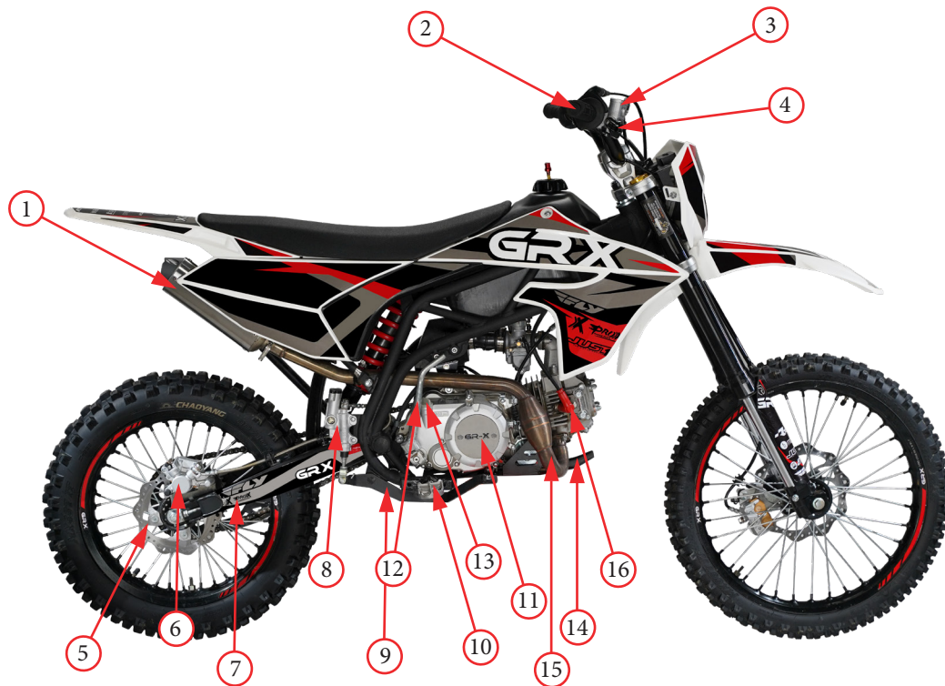
Фото 2.2. Правая сторона питбайка: 1 - глушитель; 2 - рукоятка акселератора; 3 - бачок переднего тормоза; 4 - рычаг переднего тормоза; 5 - диск заднего тормоза; 6 - задний тормозной суппорт; 7 - маятник; 8 - бачок заднего тормоза; 9 - рычаг заднего тормоза; 10 - правая подножка водителя; 11 - правая крышка картера; 12 - рычаг кик-стартера; 13 - крышка маслозаливной горловины; 14 - защита двигателя; 15 - выхлопной патрубок; 16 - свечной колпачок.
