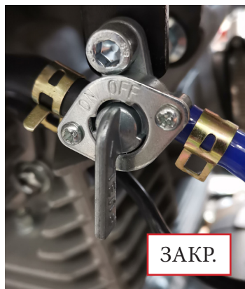
Фото 3.1. Положения крана подачи топлива.
