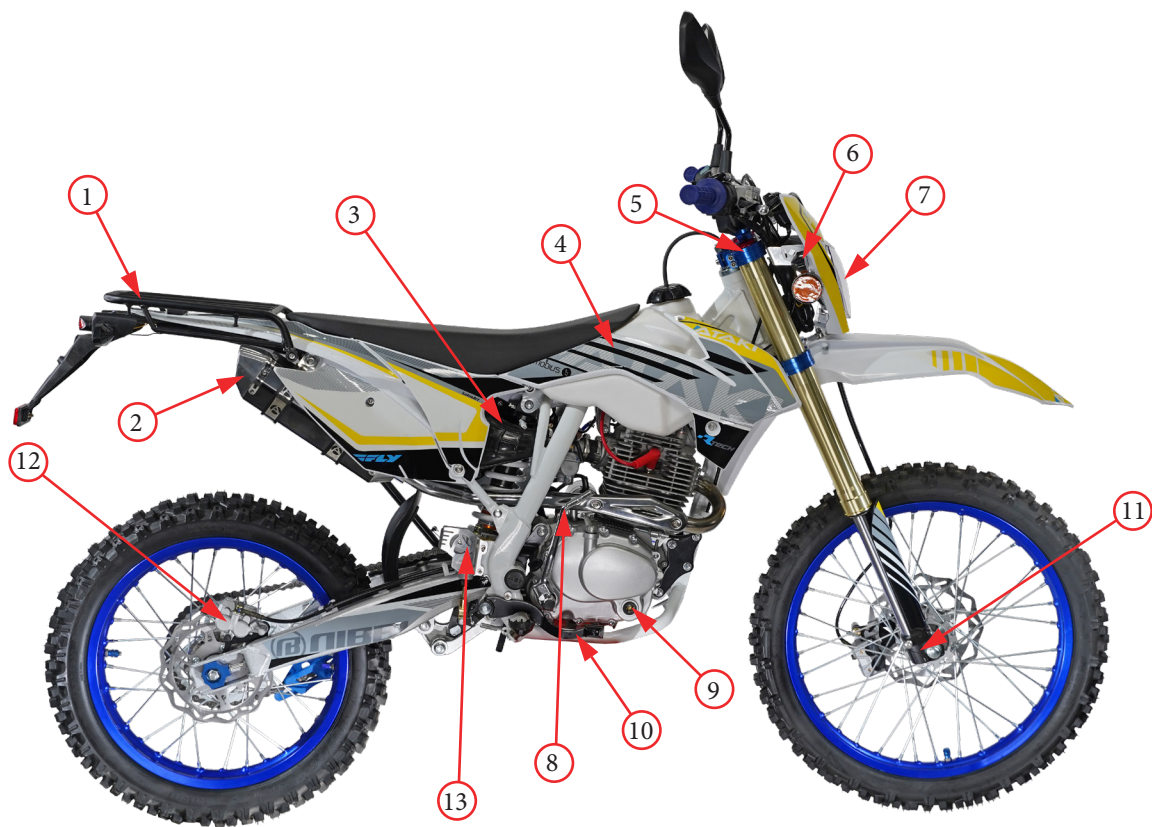
Фото 2.2. Правая сторона мотоцикла: 1 – багажник; 2 – глушитель; 3 – место расположения регулятора сжатия (не для всех моделей); 4 – бензобак; 5 – регулятор отбоя передней подвески (не для всех моделей); 6 – передние поворотные огни; 7 – фара; 8 – рычаг кик-стартера; 9 – смотровое окно контроля уровня масла; 10 – педаль заднего тормоза; 11 – регулятор сжатия передней подвески (не для всех моделей); 12 – суппорт заднего тормоза; 13 – задний тормозной цилиндр.
