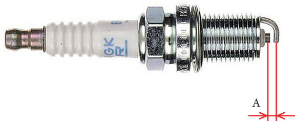
Фото 5.11. Зазор свечи зажигания.
