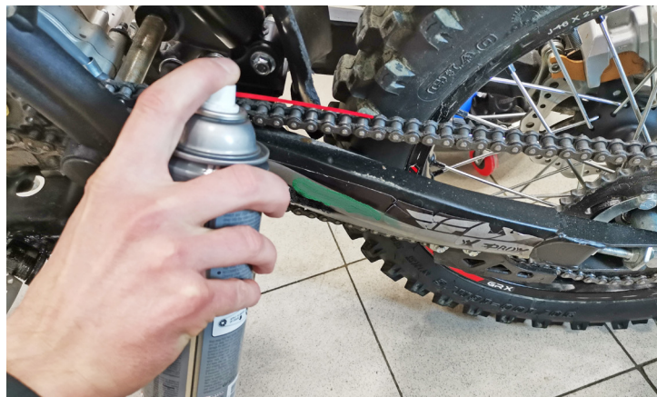
Фото 5.21. Очистка и смазка цепи.
