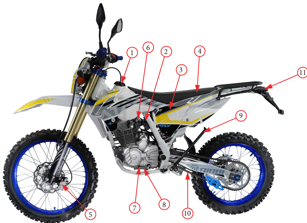
Фото 2.1. Левая сторона мотоцикла: 1 - крышка заливной горловины; 2 - карбюратор; 3 - воздушный фильтр (под сиденьем); 4 - сиденье; 5 - передний тормозной суппорт; 6 - топливный кран; 7 - рычаг переключения передач; 8 - номер двигателя; 9 - боковая подножка; 10 - приводная цепь, 11 – задние поворотные огни.
