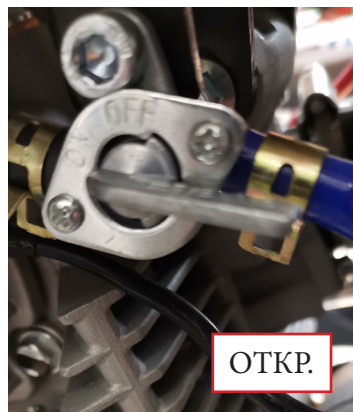
Фото 3.1. Положения крана подачи топлива.
