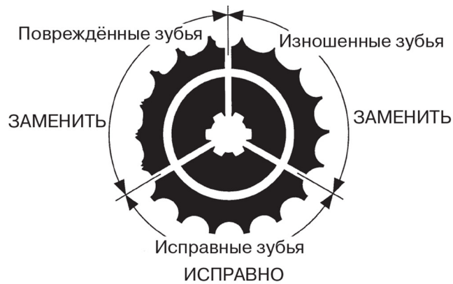
Рисунок 5.18. Вид зубьев звездочки.
