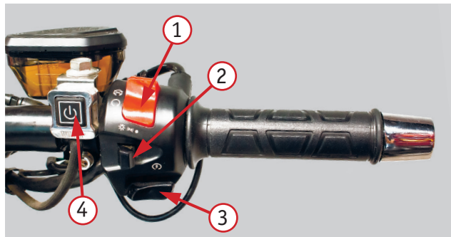
Фото 2.5. Правый комбинированный переключатель: 1 – переключатель включения/отключения питания; 2 – переключатель освещения; 3 – кнопка электростартера; 4 – кнопка включения подогрева ручек
