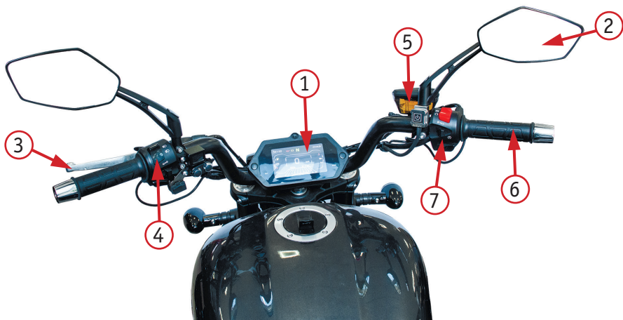
Фото 2.1. Вид руля и органов управления мотоцикла: 1 – приборная панель; 2 – зеркало заднего вида; 3 – ручка сцепления; 4 – левый комбинированный переключатель; 5 – бачок для тормозной жидкости; 6 – рукоятка газа (акселератор); 7 – правый комбинированный переключатель
