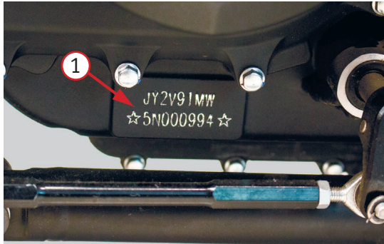
Фото 1.1. Слева на картере нанесен серийный номер двигателя – 1
