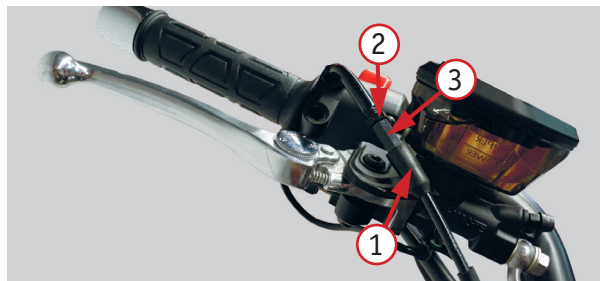
Фото 3. Регулировка троса газа: 1 – защитный колпачок; 2 – стопорная гайка; 3– регулировочная гайка
