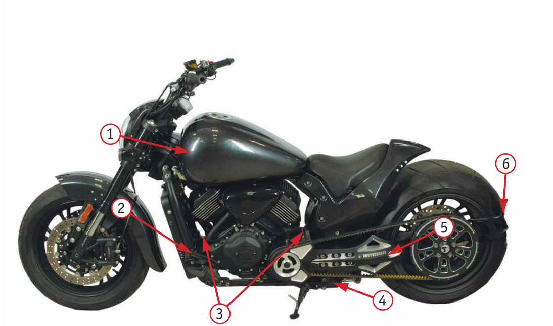
Фото 2.3. Вид слева: 1 – топливный бак; 2 – рычаг переключения передач; 3 – датчики кислорода; 4 – задний амортизатор; 5 – регулятор ремня; 6 – крепление номерного знака
