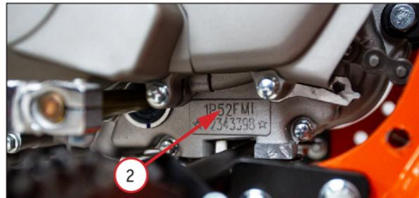
Фото 1.2. Место расположения модели и серийного номера двигателя 2
