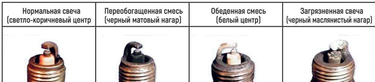
*Фото 5.10. Состояния свечей зажигания*
