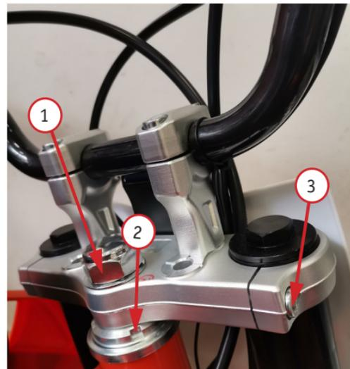
*Фото 5.28. Регулировка подшипников рулевой колонки: 1 – гайка рулевого вала; 2 – регулировочная гайка; 3 – зажимной болт верхней траверсы*
