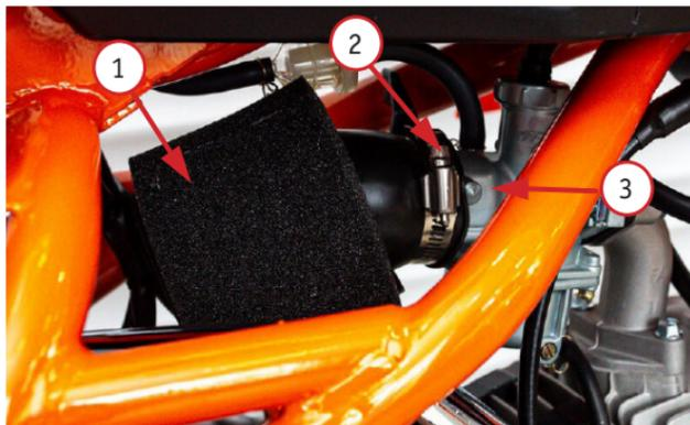
Фото 5.4. Снятие воздушного фильтра: 1 – внешний элемент воздушного фильтра; 2 – винт крепления; 3 – карбюратор
