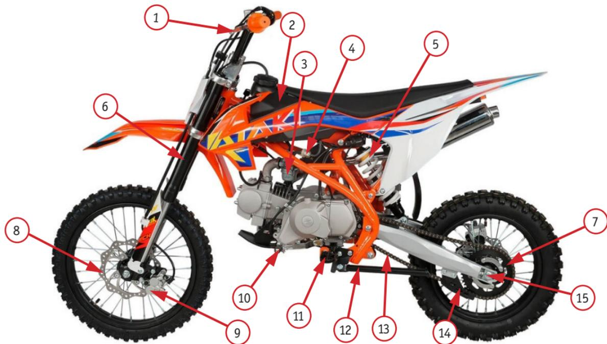
Фото 2.1. Левая сторона пилбайка: 1 – рычаг сцепления; 2 – топливный бак; 3 – карбюратор; 4 – топливный фильтр; 5 – амортизатор задней подвески; 6 – вилка переднего амортизатора; 7 – звездочка ведомая; 8 – передний тормозной диск; 9 – передний тормозной суппорт; 10 – рычаг переключения передач; 11 – подножка водителя левая; 12 – боковая подставка; 13 – приводная цепь; 14 – уловитель приводной цепи; 15 – ось заднего колеса
