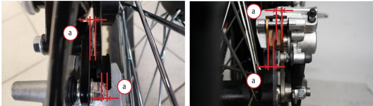
Фото 5.17. Определение износа передних и задних колодок
