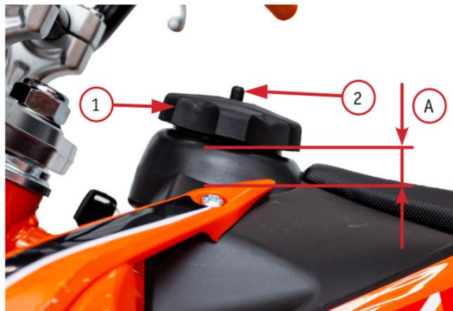
*Фото 5.1. Крышка топливного бака – 1;
