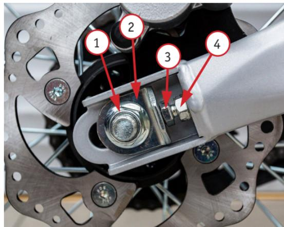
*Фото 5.24. Регулировка натяжения цепи:
