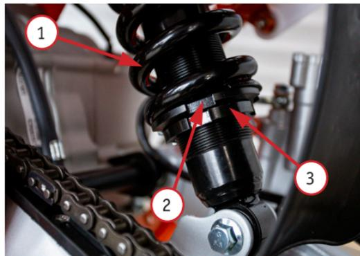
Фото 5.29. Регулировка преднатяга пружины заднего амортизатора: 1 – пружина амортизатора; 2 – регулировочная гайка; 3 – контргайка
