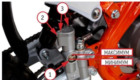
Фото 5.16. Проверка уровня и долив тормозной жидкости: 1 – смотровое окно; 2 – крышка; 3 – винты крепления крышки; максимальный уровень – МАКСИМУМ; минимальный уровень – МИНИМУМ
