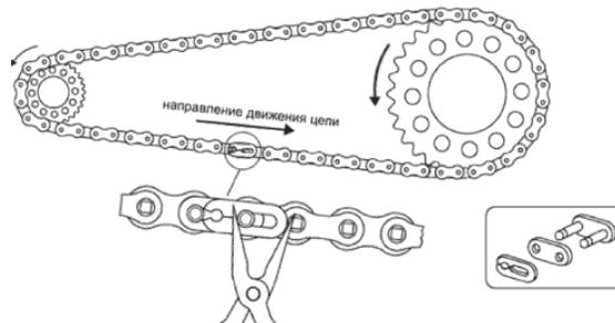
Рисунок 5.26. Установка элементов замка цепи
