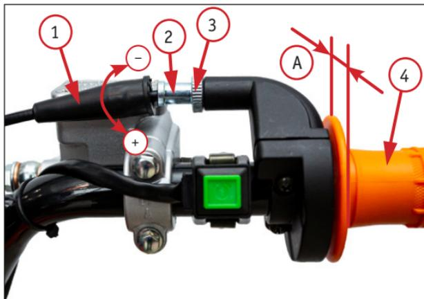
Фото 5.5. Регулировка свободного хода рукоятки акселератора: 1 – пылезащитный чехол; 2 – регулятор; 3 – стопорная гайка; 4 – ручка акселератора (газа)
