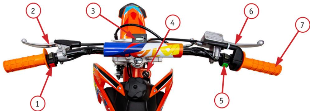
*Фото 2.3. Приборы и органы управления спереди питбайка: 1 – кнопка выключения двигателя; 2 – рычаг сцепления; 3 – счетчик моточасов (приборная панель); 4 – замок зажигания; 5 – кнопка стартера; 6 – рычаг переднего тормоза; 7 – рукоятка акселератора (газа)*
