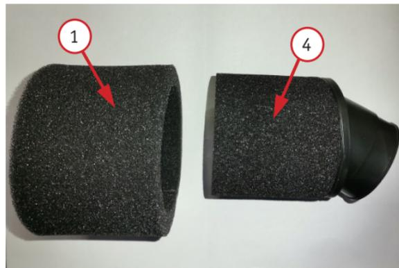
Фото 5.4.1. Фильтрующие элементы воздушного фильтра: 1 – внешний элемент; 4 – внутренний элемент
