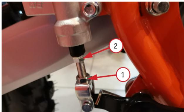
Фото 5.15. Регулировка высоты педали заднего тормоза: 1 – контргайка; 2 – регулировочный болт
