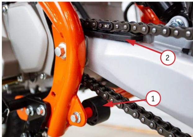
Фото 5.23. Ролик натяжения цепи – 1, слайдер-успокоитель – 2
