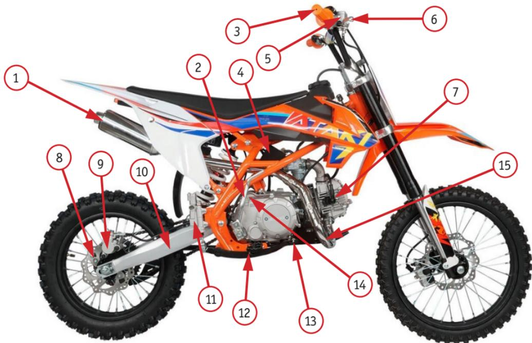
Фото 2.2. Правая сторона питбайка: 1 – глушитель; 2 – рычаг кик-стартера; 3 – рукоятка акселератора (газа); 4 – воздушный фильтр; 5 – бачок переднего тормоза; 6 – рычаг переднего тормоза; 7 – свечной колпачок; 8 – диск заднего тормоза; 9 – задний тормозной суппорт; 10 – маятник; 11 – бачок заднего тормоза; 12 – правая подножка водителя; 13 – педаль заднего тормоза; 14 – крышка с щупом маслязаливной горловины; 15 – выхлопной патрубок
