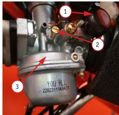
*Фото 3.1. Ручка обогащения / обеднения топливной смеси – 1; 2 – винт регулировки холостого хода; 3 – карбюратор*
