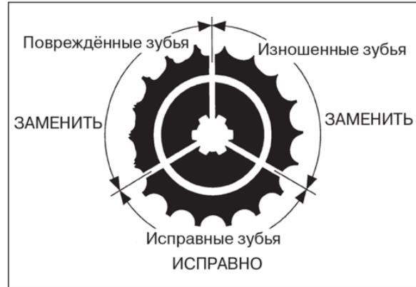
*Рисунок 5.22. Вид зубьев звездочки*
