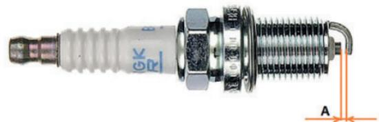
Фото 5.11. Зазор свечи зажигания «А»
