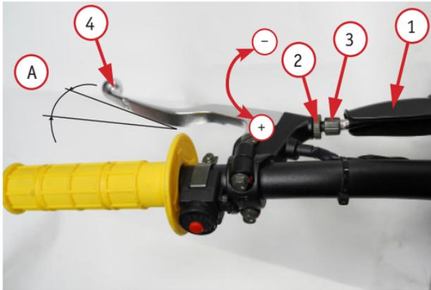
Фото 5.7. Регулировка свободного хода рычага сцепления: 1 – пылезащитный чехол; 2 – стопорная гайка; 3 – регулятор; 4 – рычаг сцепления
