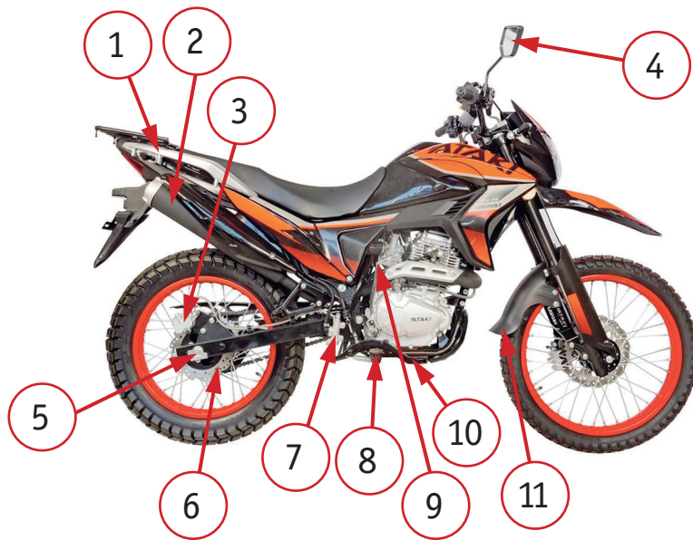
Фото 2.3. Правая сторона мотоцикла: 1 – задний правый поворотный сигнал; 2 – глушитель; 3 – задний тормозной суппорт; 4 – правое зеркало заднего вида; 5 – гайка крепления заднего колеса; 6 – задний тормозной диск; 7 – задний тормозной цилиндр; 8 – правая подножка водителя; 9 – кикстартер; 10 – рычаг задних тормозов; 11 – передний брызговик.
