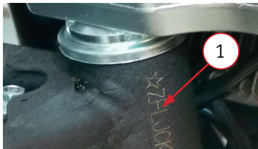
Фото 1.1. Надпись VIN номера 1 нанесена на рулевом стакане.
