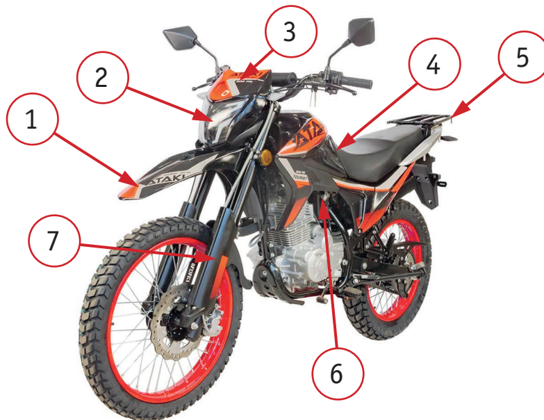
Фото 2.1. Вид спереди: 1 – крыло переднего колеса; 2 – фара; 3 – ветровое стекло; 4 – сиденье; 5 – задний багажник; 6 – бензотанк; 7 – защита пера вилки.
