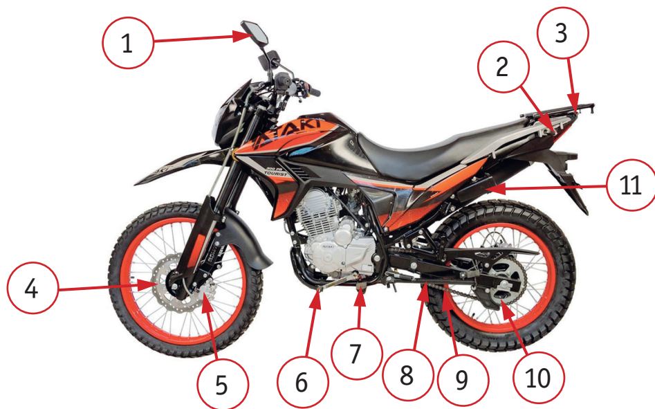
Фото 2.4. Левая сторона мотоцикла: 1 – левое зеркало заднего вида; 2 – задний левый поворотный сигнал; 3 – задний фонарь; 4 – передний тормозной диск; 5 – передний тормозной суппорт; 6 – рычаг переключения передач; 7 – левая подножка водителя; 8 – боковая подставка; 9 – цепь; 10 – задняя звезда; 11 – инструментальный ящик.
